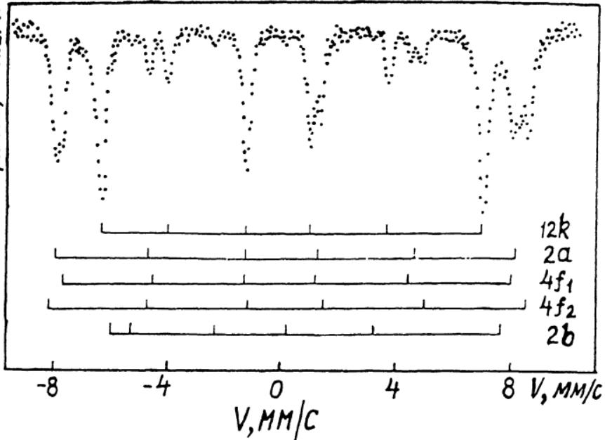
Мессбауэрский спектр образца из постоянного магнита марки 16 БА-190. Плоскость среза образца перпендикулярна оси текстуры.
