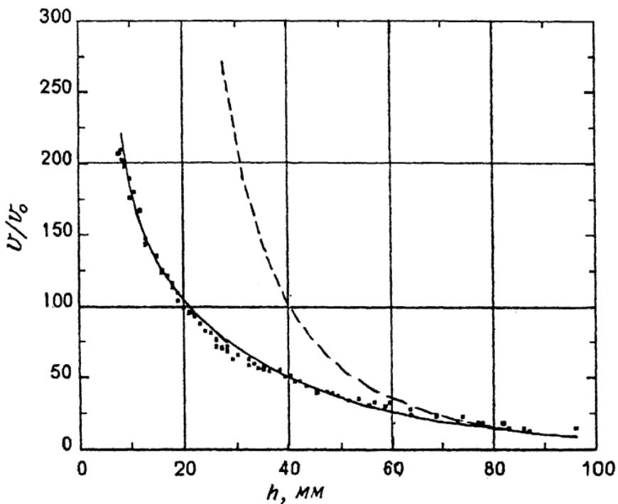
Зависимость амплитуды электромагнитного отклика от расстояния между датчиком и поверхностью образца; точки — экспериментальные значения; сплошные и пунктирные линии — теоретические зависимости (7) и (5) соответственно.
