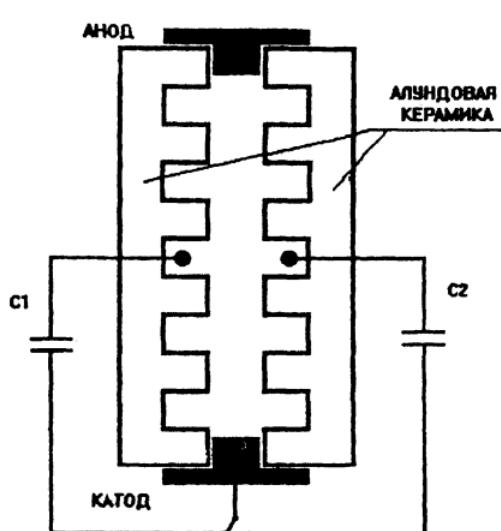
ный зазор — 25 мм. Лазер работал со схемой Блюмляйна (емкости плеч схемы 2...16.5 нФ, напряжение питания 5...25 кВ) и обеспечивал импульсную генерацию на УФ переходе  $C^3\pi_u - B^3\pi_g$  молекулы азота с длиной волны 337.1 нм.
