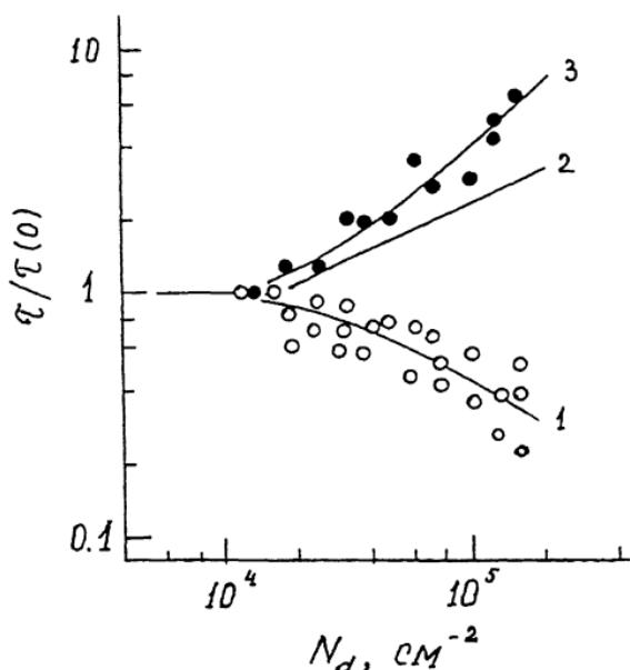
Зависимости времени жизни неосновных носителей тока  $\tau$  от плотности дислокаций  $N_d$  в кристаллах ПИН GaAs, выращенных из расплава с избытком мышьяка (1); с составом, близким к стехиометрическому (2); с избытком галлия (3).
