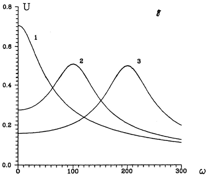
Зависимость максимальной среднеквадратичной скорости конвекции от частоты модуляции микроускорений.
