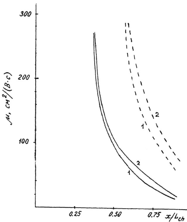
Зависимость средней подвижности электронов  $\mu$  от координаты  $x$  вдоль канала.
