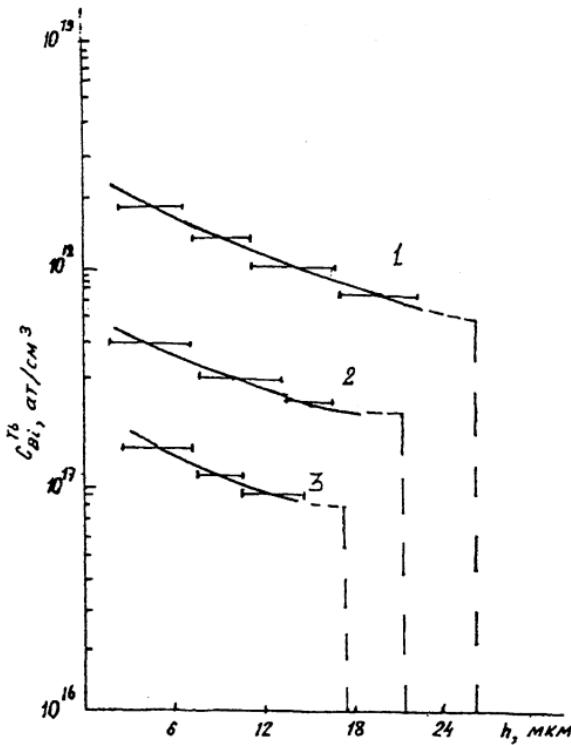
Концентрационные профили распределения висмута в эпитаксиальных слоях фосфида индия, полученных при различных исходных температурах (1 — 700°С, 2 — 750°С, 3 — 800°С). Вертикальные штриховые линии соответствуют границе подложка-слой.
