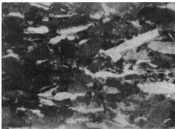
Рис. 4. Структура компакта из сплава 9КСР ( a — \times 315 без травления и b — \times 200 после травления).
