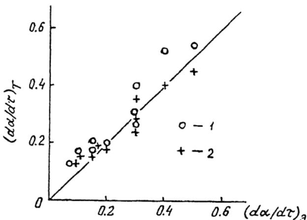
Сравнение теоретического темпа изменения коэффициента теплоотдачи  $(\frac{d\alpha}{d\tau})_t$  и экспериментального  $(\frac{d\alpha}{d\tau})_e$ . Точки: 1 — расчет по формуле (2); 2 — расчет по формуле (7).
