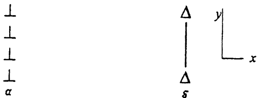
Рис. 2. Малоугловая граница разориентации (а) и ее представление в виде дисклинационного диполя (б).
