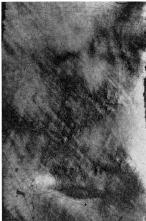
Рис. 3. Микроснимок люминесцирующего при 295 К кристалла AgBr : Cl^- , облученного из видимой области спектра через стекло ФС-6. Получен в скрещенных поляризаторах.
