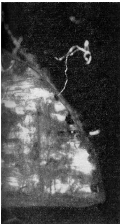
Рис. 1. Микроснимок люминесцирующего кристалла \text{AgCl} : \text{Eu}^{2+} (0.02 мол.%) в скрещенных поляризаторах. \times 25 .
