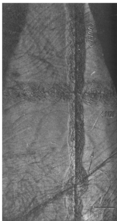
Рис. 2. Рентгеновская топограмма одного из кристаллов после отжига при 2500 °С.
