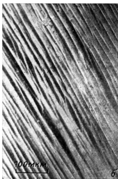
Рис. 4. Ступени скольжения в образцах, деформированных растяжением при 300 °С ( 0.5 T_{пл} ) до \epsilon=12\% (середица переходных стадий II—III) (а) и \epsilon=30\% (окончание III стадии) (б).
