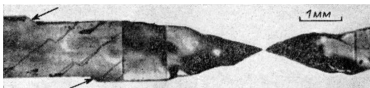
Рис. 3. Вязкое разрушение при растяжении. T=800^\circ\text{C} ( 0.94 T_{\text{пл}} ).
