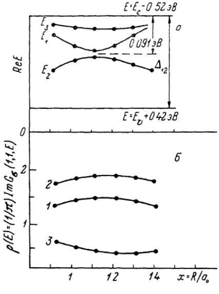
Зависимость энергии связи (а) и плотности состояний (б) от межатомного расстояния (показана дислокационная зона Si).
