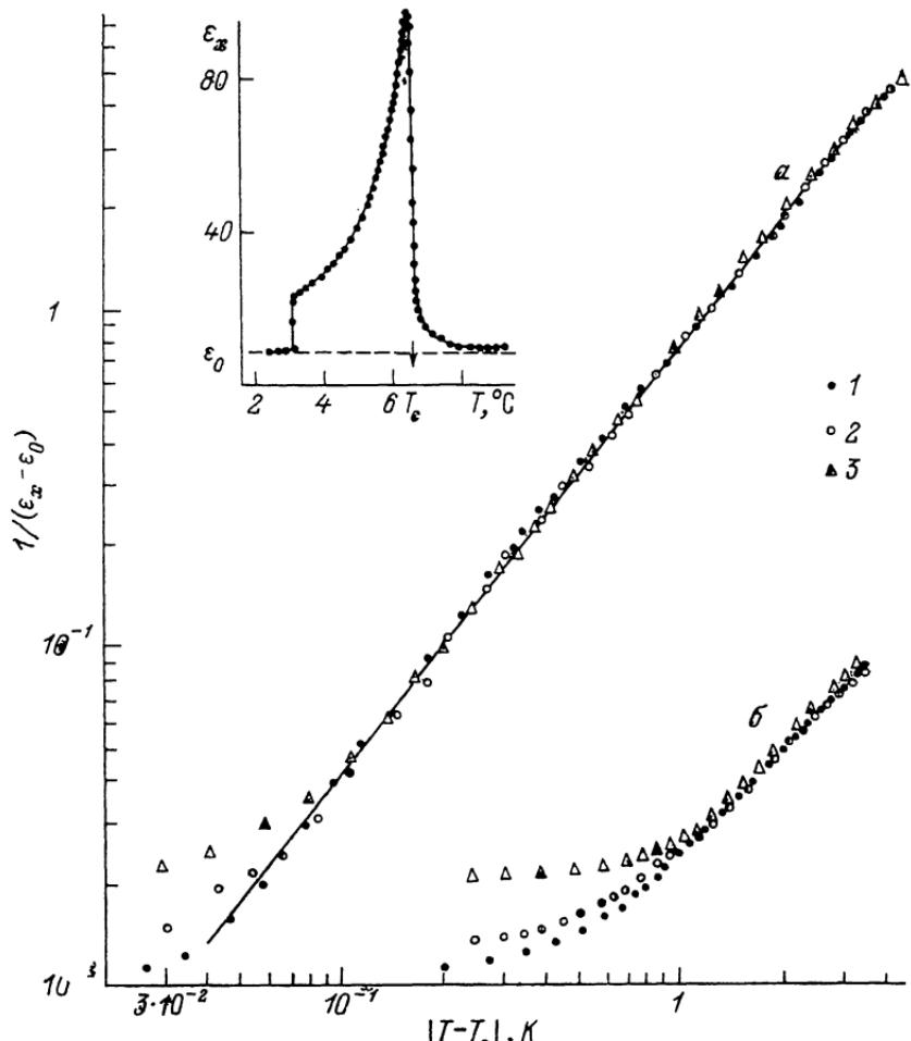
Температурная зависимость аномальной части диэлектрической проницаемости в па-
