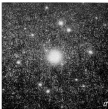
Рис. 5. Электронограмма (а) и микрофотография (б) образца (110) Cu—(110) Ag с \theta \approx 54^\circ после отжига.
