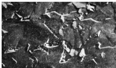
Рис. 2. Электронно-микроскопический снимок поверхности для пленки n-Bi_2Te_3 № 2 (см. таблицу).
