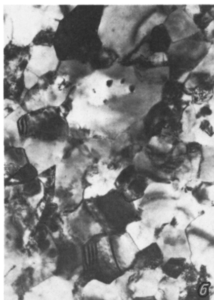
Рис. 2. Микроструктура деформированной меди.
