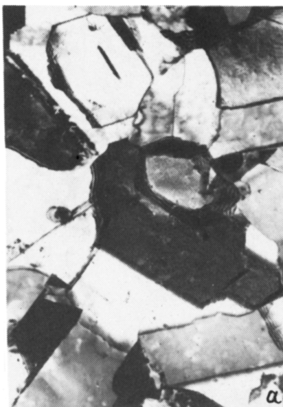
Рис. 2. Микроструктура деформированной меди.
