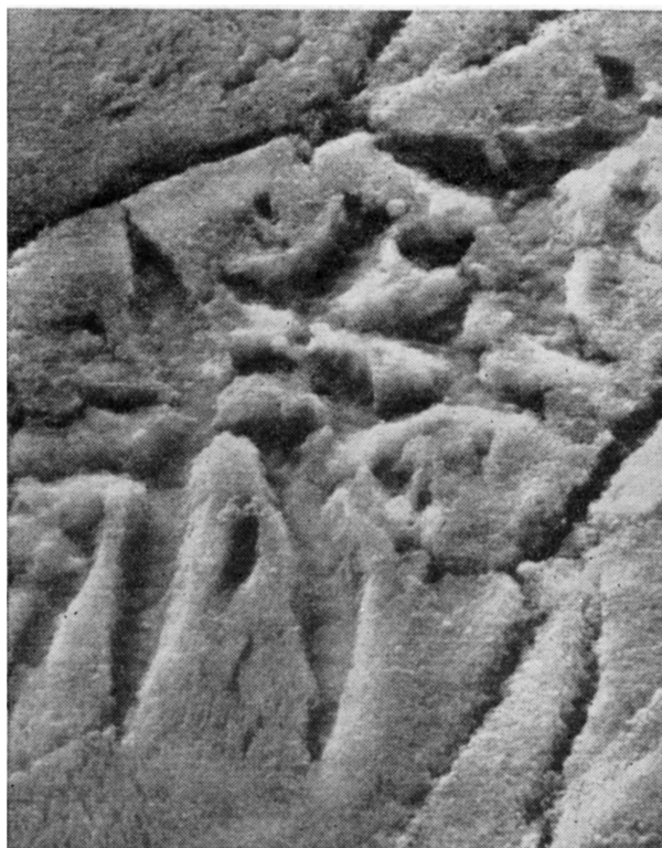
Рис. 3. Электронно-микроскопическая картина поверхности толстой (500 мкм) пластины кремния после лазерного воздействия, проводимого при температуре 100 °С.
