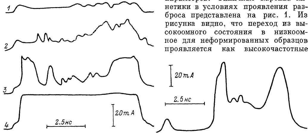
Рис. 1. Осциллограммы тока при электрической наносекундной «формовке» переключающего элемента на основе \text{Ge}_{0.15}\text{Te}_{0.85} толщиной 0.56 мкм.
