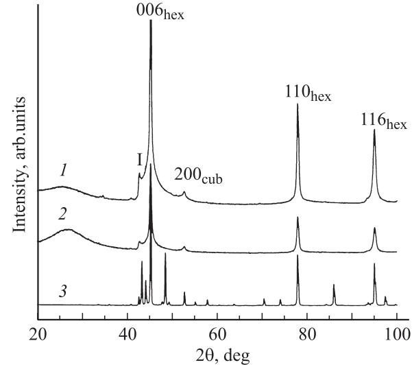
**Рис. 1.** Дифрактограммы порошков карбида кремния. 1 — нанопорошок SiC-4; 2 — нанопорошок SiC-2; 3 — технический порошок SiC. Гексагональные индексы указаны для модификации 6H. I — дифракционный максимум от размытого узла (100).
