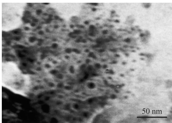
**Рис. 3.** Нанокристаллы SiC-4 после травления оболочки из диоксида кремния в растворе фтористоводородной кислоты (по данным ПЭМ).
