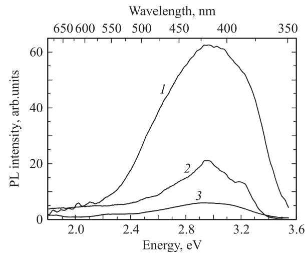
**Рис. 7.** Спектры люминесценции. 1 — нанокристаллы SiC-2; 2 — нанокристаллы SiC-4; 3 — монокристалл 6H-SiC.
