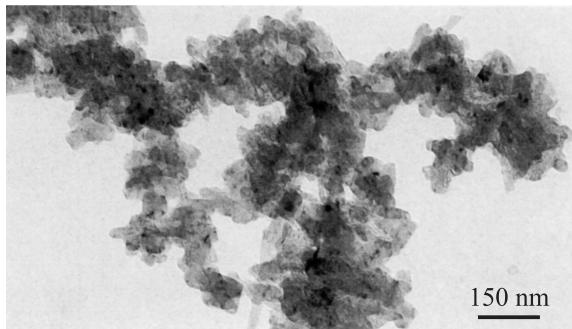
**Рис. 2.** Нанокристаллы SiC-2, капсулированные внутри аморфных частиц  $\text{SiO}_2$  (по данным ПЭМ).
