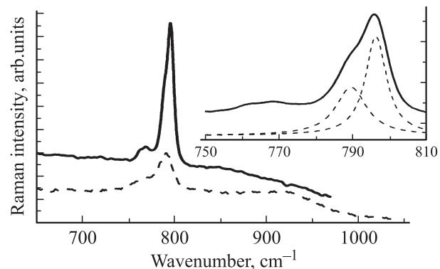
**Рис. 5.** Спектры КР образцов SiC-4 (сплошная) и SiC-2 (штриховая линия). На вставке — спектр образца SiC-4 в увеличенном масштабе (сплошная линия) и результат аппроксимации полосы около 795  $\text{cm}^{-1}$  двумя лоренцианами (штриховые линии).
