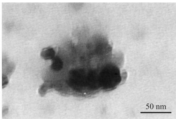
**Рис. 4.** Агрегат нанокристаллов SiC-4 и аморфных частиц  $\text{SiO}_2$ . В левом верхнем углу агрегата наблюдается частица SiC в форме гексагональной призмы (по данным ПЭМ).
