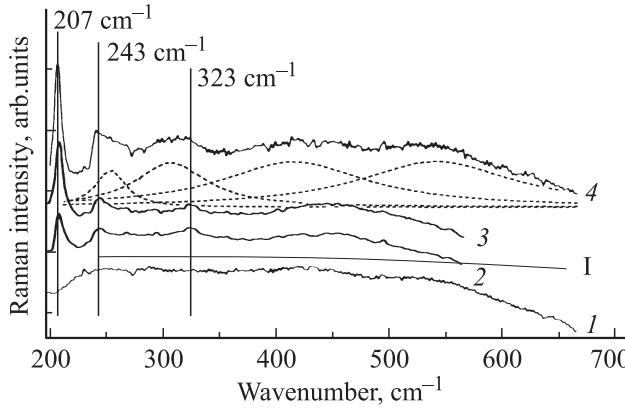
**Рис. 6.** Спектры КР образца SiC-2 (I) и образца SiC-4 (кривые 1–4 соответствуют разным точкам образца). Штриховые линии — лоренцевские контуры аппроксимирующие кривую 4.
