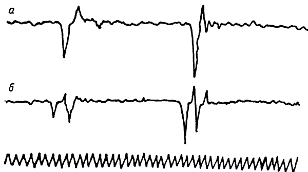
Рис. 5. Флуоресценция Li на \lambda_2=460.3 нм в отсутствие электрического поля (а) и при поле F=50 кВ/см (б).
