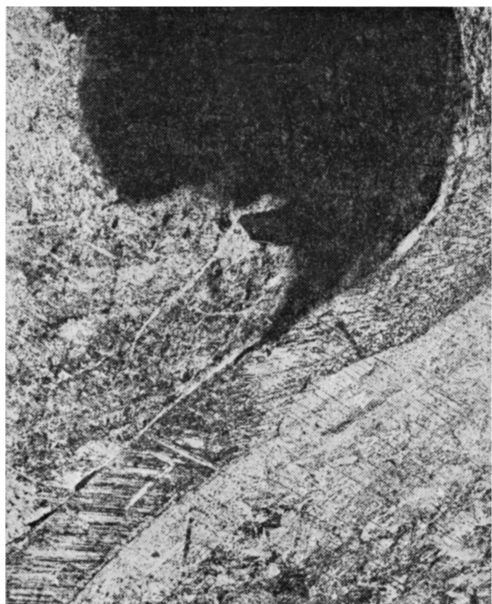
Рис. 2. Микроструктура поперечного сечения образца из титанового сплава в боковой области каверны (100 \times ).
