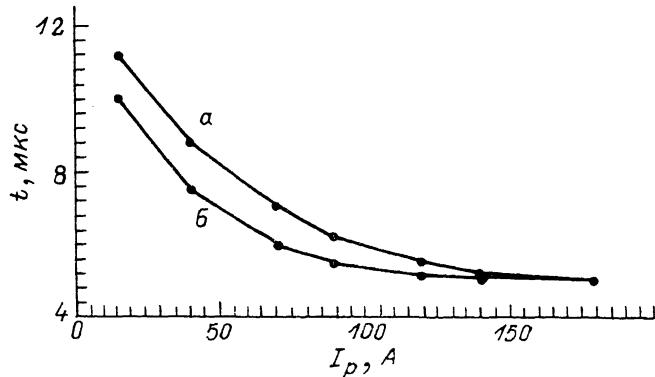
Зависимость времени коммутации от амплитуды импульса поджига.
