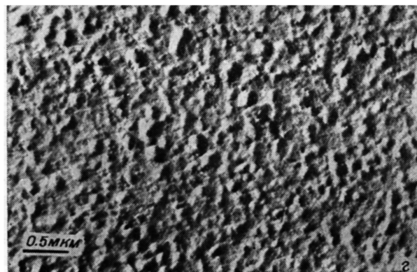
Рис. 1. Микрофотографии реплик поверхности аморфизованных слоев ПКК на монокристаллических кремниевых подложках до (а) и после перекристаллизации импульсным ( \tau_p = 50 нс) излучением с \lambda = 1.06 мкм при плотности энергии 0.5 (б), 0.7 (в) и 1 Дж/см 2 (г).
