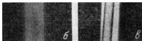
Рис. 2. Изменение интенсивности пропускания при сканировании полиэтиленового цилиндра щелью в условиях абсорбционного (1) и рефракционно-абсорбционного контраста (2) (а), абсорбционная рентгенограмма (б), рефракционно-абсорбционная рентгенограмма (в).
