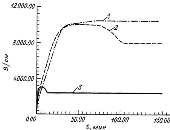
Распределение напряженности электрического поля при формировании электростимулированных ионно-обменных волноводов в стеклах.
