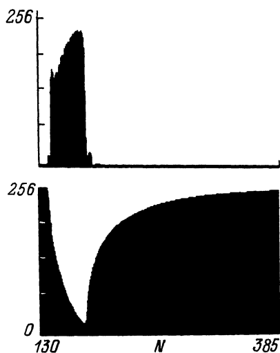
Рис. 5. Форма импульса тока пучка (верхний снимок) и соответствующий ему I_{н.р}(t) в азоте. Временная шкала составляет 12.8 мкс.
