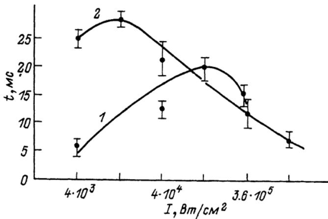
Зависимость времени жизни плазмы оптического пробоя, образованного лазерным излучением длиной волны 1.06 мкм (1 - на стеклянных нитях, 2 - на углеродной мишени).
