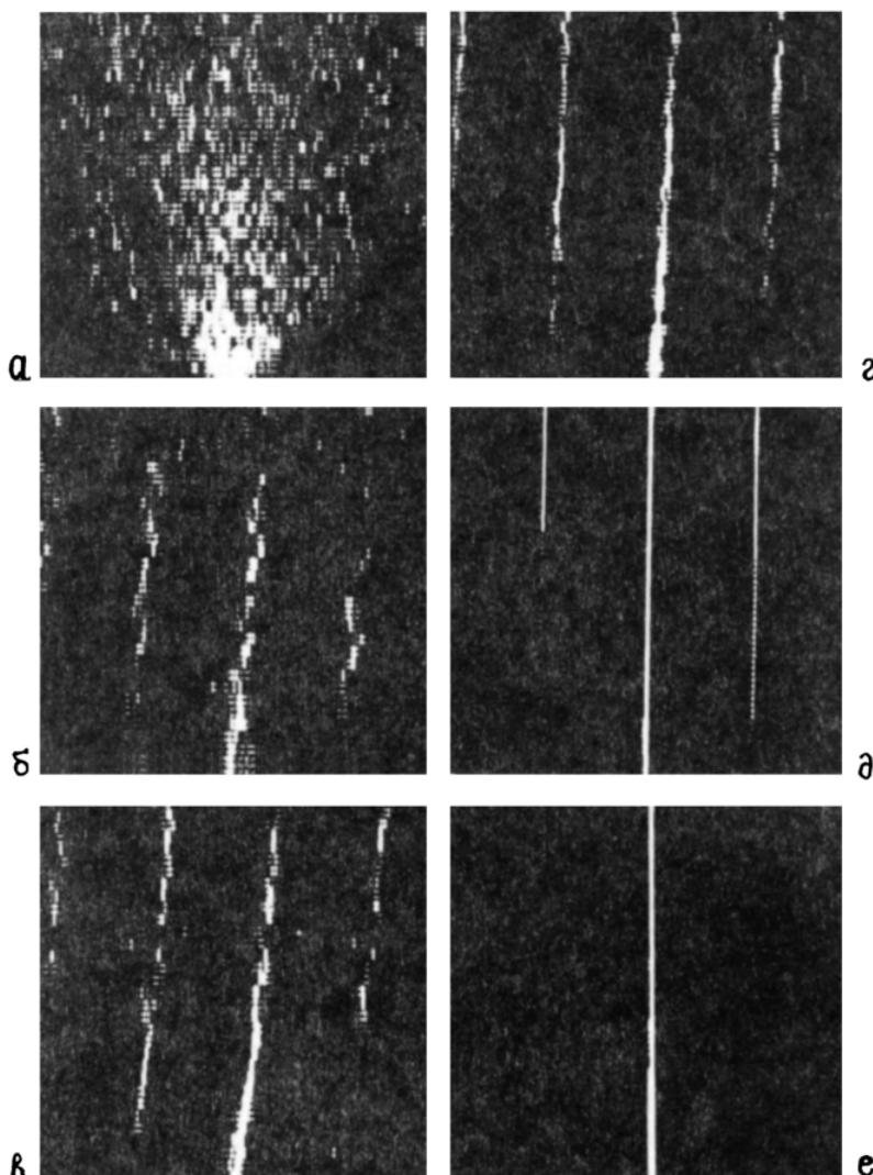
Двумерные плотности распределения разности фазовых спектров  $\rho(\Delta\varphi|\omega)$  с увеличением коэффициента связи в системе взаимосвязанных хаотических генераторов. По вертикали отложена частота  $0 \leq \omega \leq \omega_1$ , по горизонтали – разность  $-2\pi \leq \Delta\varphi \leq 2\pi$ . Яркость точек на графиках пропорциональна величине  $\rho(\Delta\varphi|\omega)$ . Результаты получены численным моделированием на ПЭММ.
