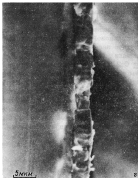
Рис. 2. Морфология пленок, полученных при разных технологических режимах по данным сканирующей электронной микроскопии: а) P_{O_2} = 1 Тор, T_{пл} = 670 °С (текстура отсутствует); б) P_{O_2} = 0.5 Тор, T_{пл} = 750 °С (текстура (001); заметно ориентирующее действие подложки); в) P_{O_2} = 1 Тор, T_{пл} = 730 °С (смешанная текстура (001) + (h00)); г) поперечный разлом этой же пленки.
