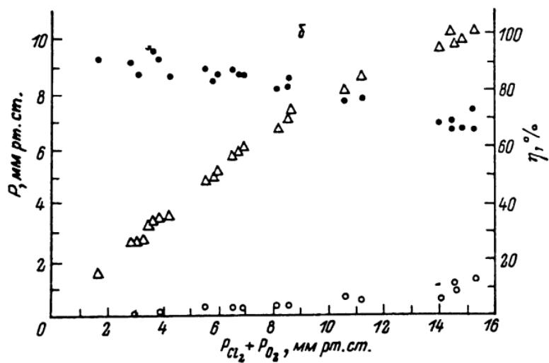
Зависимость давления синглетного кислорода (1), давления хлора (2) и содержания синглетного кислорода  $\eta$  (3) на выходе генератора от суммарного давления кислорода и хлора на выходе генератора для удельной поверхности генератора  $G = 1 \text{ см}^{-1}$  (а) и  $G = 2 \text{ см}^{-1}$  (б).
