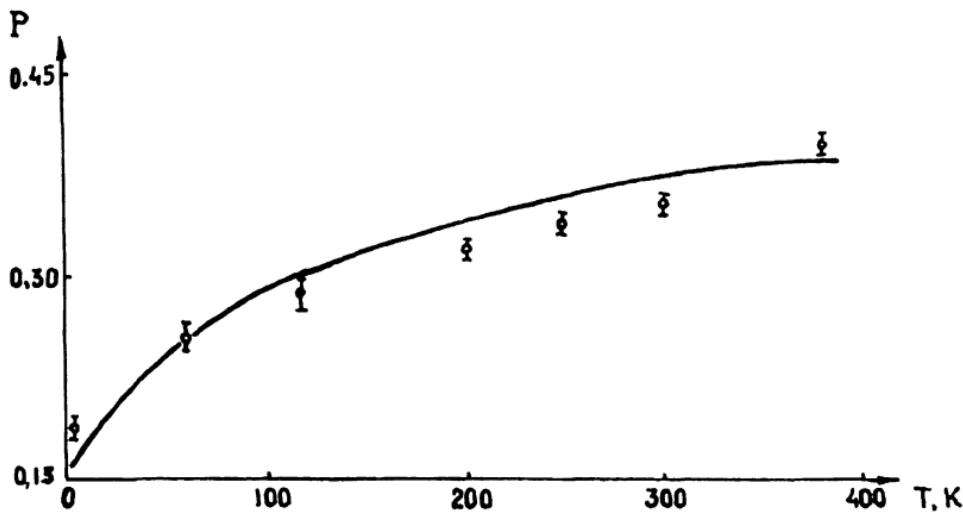
Зависимость вероятности захвата позитронов сферическими дефектами в алюминии, облученном быстрыми нейтронами. Кружки – экспериментальные точки, сплошная линия – теоретический расчет.
