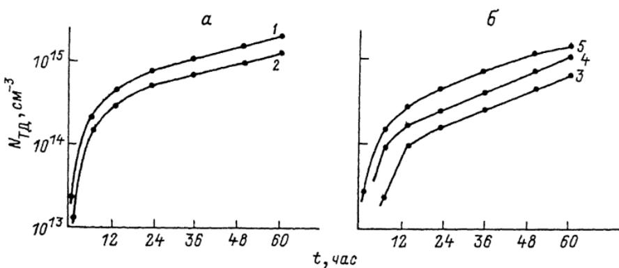
Изменение концентрации ТД в процессе ТО при 450 °С. Номера кривых соответствуют номерам образцов в таблице.
