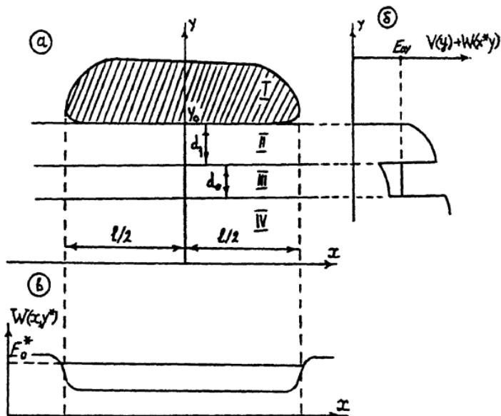
а - разрез рассматриваемой структуры: 1 - металлическая дорожка, П - изолирующий слой  $Al_xGa_{1-x}As$ , Ш - слой  $GaAs$ , 1У - подложка из  $Al_xGa_{1-x}As$ ; б - вид потенциального рельефа в сечении  $x=x^*$ ,  $x_1 < x < x_2$ ; в - вид потенциального рельефа в сечении  $y=y^*$  для  $y^*$  из области Ш.
