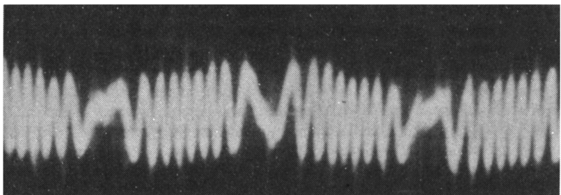
Рис. 2. Осциллограмма выходного сигнала спекл-интерферометра вибраций с амплитудной модуляцией (а) и с устраненной амплитудной модуляцией за счет введения блокирующего экрана в приемную апертуру (б).
