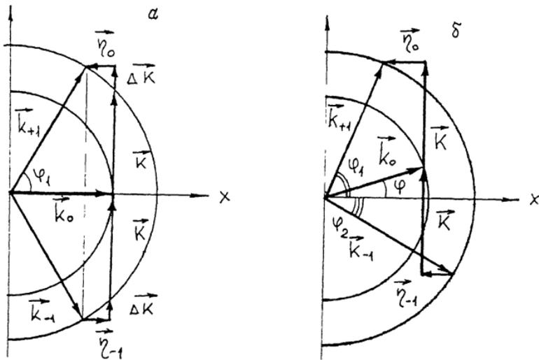
Векторные диаграммы брегговского взаимодействия; а - при вариациях частоты ультразвука, б - при изменениях угла падения света.
