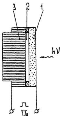
уменьшения поверхностной рекомбинации фотоиндуцированных носителей тока. Электрический контакт на фотоприемной поверхности обеспечивает напыленный полупрозрачный слой железа, имеющего малые коэффициенты отражения и поглощения в регистрируемом спектральном диапазоне.
