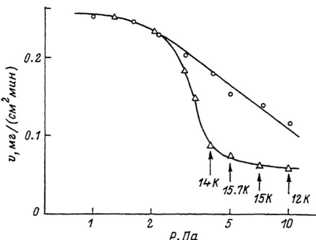
Зависимость скорости осаждения покрытий, измеренная при распылении Nb мишени в аргоне (кружки) и в смеси аргон-азот (треугольники). Стрелки указывают  $T_c$  полученных пленок.
