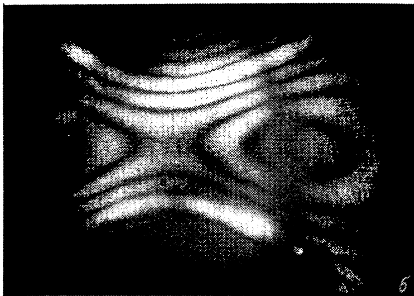
Рис. 4. Интерферограммы усредненных во времени собственных колебаний ( \alpha = 1 , \beta = 3 ).
