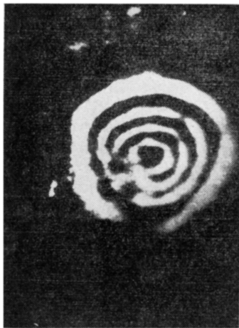
Рис. 3. Двухэкспозиционная интерферограмма возбужденной области кремния ( \tau = +60 \text{ пс} ).
