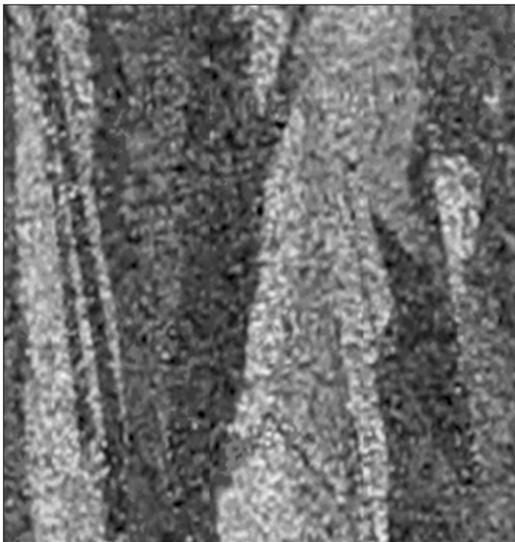
Рис. 1. Фотография типичного образца мультикристаллического кремния. Фрагмент размером  $1.0 \times 1.0$  см.
