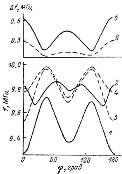
Анизотропия частоты автогенератора  $f$  (1—4) и фотоиндукционного изменения  $\Delta f$  (5, 6) на диске (110)  $\text{Y}_3\text{Fe}_5\text{O}_{12}$ , выращенного из растворителя  $\text{BaO}-\text{B}_2\text{O}_3$ .
