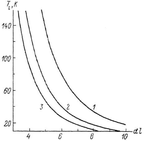
Зависимость температуры  $T_l$ , при которой проводимость периодически-неупорядоченной системы начинает контролироваться прыжками между ближайшими проводящими слоями толщиной  $d$ , от толщины изолирующих слоев  $l$  для ряда значений  $d$ :  $ad=5$  (1),  $10$  (2),  $15$  (3).
