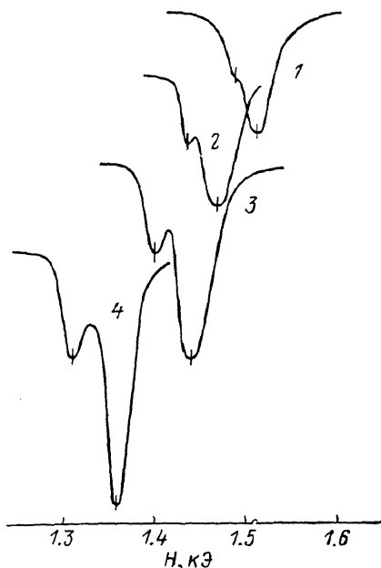
Рис. 3. Линии АФМР при \nu = 0.732 ГГц в интервале температур 4.2—1.5 К.
