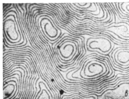
Рис. 2. Динамическая доменная структура пленки при частоте магнитного поля f = 1 кГц и амплитуде H_{\sim} = 52 Э.
