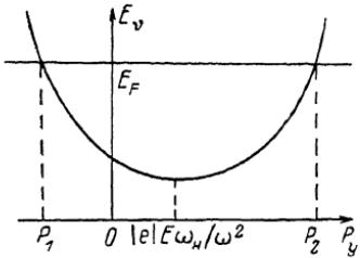
Зависимость  $n$ -го энергетического уровня электронов проводимости от поперечного импульса  $p_y$  в случае параболического потенциала (2).
