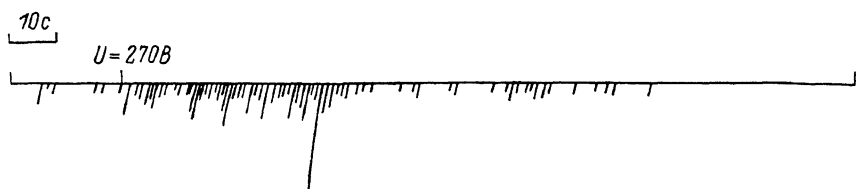
Рис. 3. Изменение интенсивности АЭ, возникающей в монокристаллах CdS при длительном воздействии на образец постоянного напряжения.
