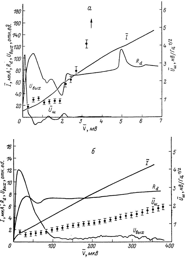
BAX, зависимости дифференциального сопротивления  $R_d$ , выходного напряжения  $U_{\text{вых}}$  и шумового напряжения  $\bar{U}_w$  от напряжения смещения на переходах с параметрами:  $R_N=46$  Ом,  $V_c \sim 500$  мкВ (a) и  $R_N=137$  Ом,  $V_c \sim 140$  мкВ (b).
