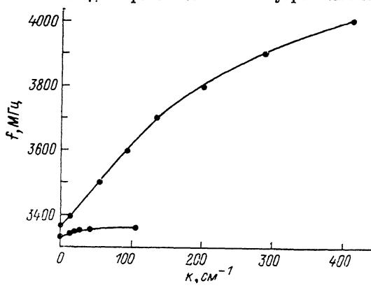
пространяющейся в прямом направлении. Получить дисперсионную ветвь внутренней поверхностиной МСВ при изменении направления распространения не удалось: ее ветвь в этом случае должна располагаться в нижней части частотного интервала и быстро загибаться вниз.
